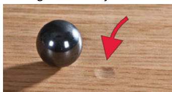
Deska dębowa warstwowa (36,5 N/mm 2 )
