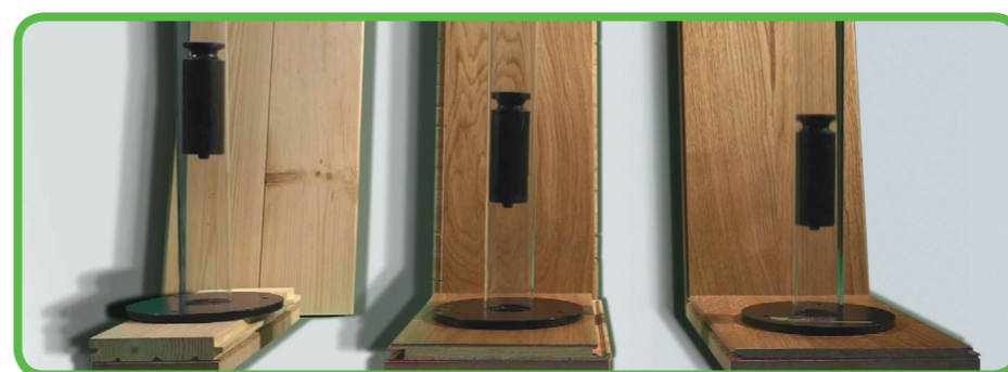
PORÓWNANIE TWARDOŚCI PODŁÓG (deska sosnowa | deska warstwowa | deska Venifloor)
