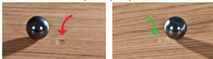
Planche en chêne stratifiée (36,5 N/mm 2 )
