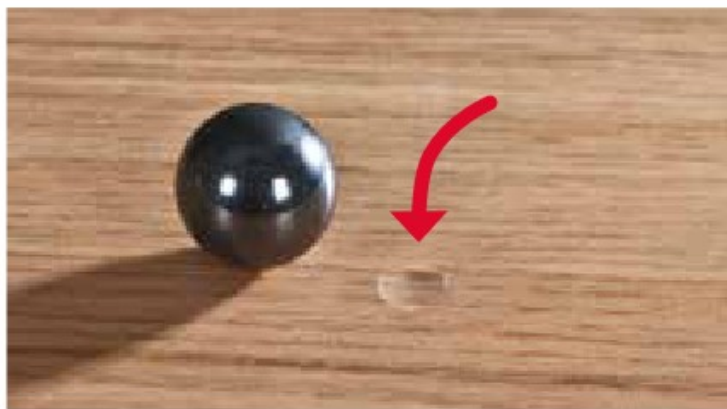
Deska dębowa warstwowa (36,5 N/mm 2 )
